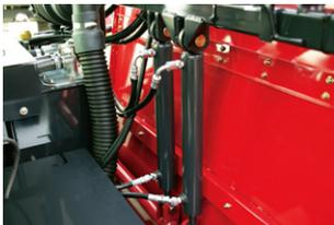
ブラシフレームのシリンダーを2本にしてブラシの転がり抵抗を下げること、タイヤの接地圧が高まり、登坂力をアップさせます。
